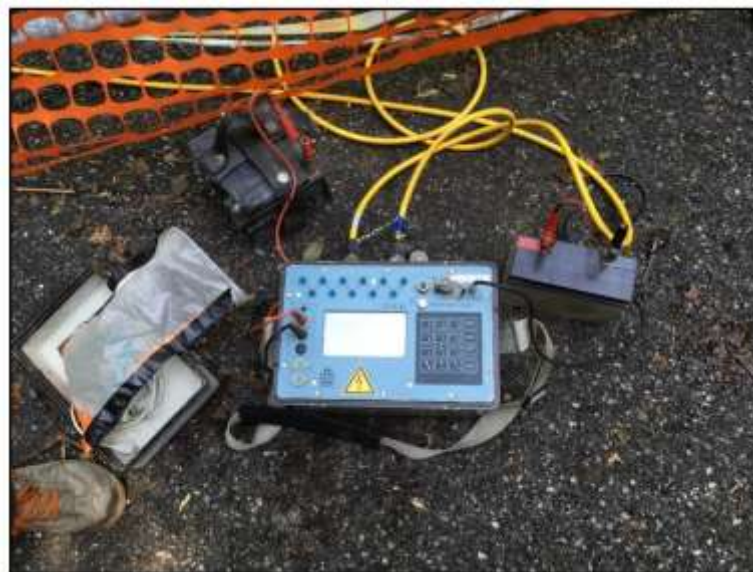
Figura 10: Strumentazione utilizzata (georesistivimetro Syscal Pro) (Techgea S.r.l.)
